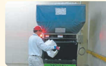
発泡スチロールの箱を破碎・溶解し原料に加工するようす
